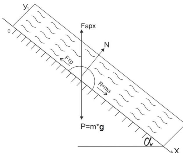
Рис4. Схема движения частицы по донной поверхности горной реки:  $P=mg$ - сила тяжести частицы;  $F_{арх}$  – архимедова сила;  $N$ - сила давления;  $F_{тр}$ -сила трения;  $P_x=ma$  – сила инерции;  $m$ - масса частицы;  $a$  – ускорение частицы.
