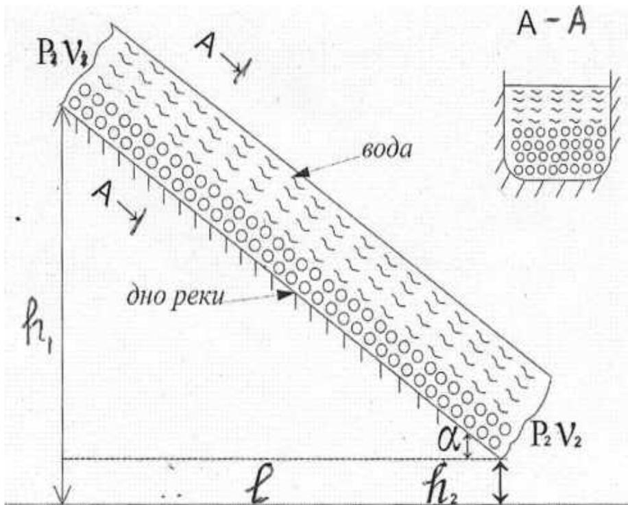
Рис.3 Двухслойное течение горной реки:  $h_1$  и  $h_2$  соответствующие высоты донной части горной реки по отношению к горизонту;  $P_1$  и  $P_2$  – давление соответственно на высоте  $h_1$  и  $h_2$ ;
